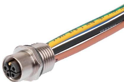
您的外围设备应配备更大的电源。借助我们新的 M12 接插件，超过 250 V 和 2 A 的电压不会出现任何问题。紧凑型 A-、K-、L-、S- 和 T-编码 M12 接插件用于传输最高 630 V 交流电或 60 V 直流电的电压以及 12 A 的电流。
