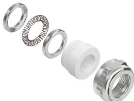
随着电子组件的灵敏度不断提高, 电磁干扰频率不断提高, 电缆接头需要在系统的屏蔽概念中发挥重要作用。这类EMC电缆接头采用360°筛查接线点, 可屏蔽干扰频率。手指锁定密封件可提供出色的电缆保持和张力释放效果, 其旁边的电缆接头符合EN 62444的机械要求。专利设计让组装变得轻松快捷。
