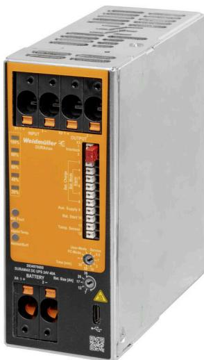
UPS控制单元带有相应的电池模块，与供电单元形成一个完整的直流UPS系统。正常运行时，UPS控制单元的输入电压与负载直接相联。出现主线故障(直流输入电压锐减)时，系统转用电池供电。主线供电恢复后，系统转回正常运行状态，内置充电器对电池充电至饱和。
