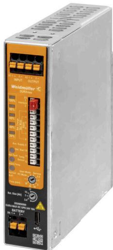
UPS控制单元带有相应的电池模块，与供电单元形成一个完整的直流UPS系统。正常运行时，UPS控制单元的输入电压与负载直接相联。出现主线故障(直流输入电压锐减)时，系统转用电池供电。主线供电恢复后，系统转回正常运行状态，内置充电器对电池充电至饱和。
