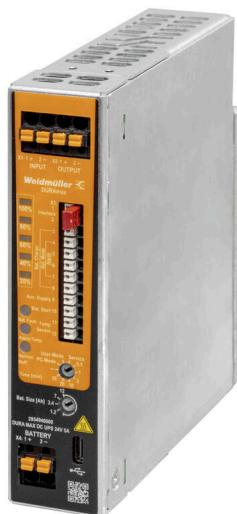
UPS控制单元带有相应的电池模块，与供电单元形成一个完整的直流UPS系统。正常运行时，UPS控制单元的输入电压与负载直接相联。出现主线故障(直流输入电压锐减)时，系统转用电池供电。主线供电恢复后，系统转回正常运行状态，内置充电器对电池充电至饱和。
