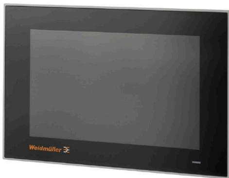
魏德米勒的 u-view 高级触摸屏具有出色的图像质量，可用于大多数工业环境。该产品组合支持从 7 英寸到 21.5 英寸的屏幕尺寸，并提供高分辨率电容式触摸屏，支持滑动手势和手套操作。所有面板都配备了 Linux 操作系统和支持 HTML5 的浏览器，并通过集成的信息亭模式及其简单的配置针对 web 应用程序进行了优化。因此，它们是基于 web 的可视化的完美解决方案，并支持访问各种 web 服务器，如 u-OS、u-create PROCON-WEB、u-control web 等等。面板采用特别扁平的设计，带有工业级 IP66 外壳。
