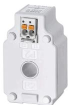
CMA-CTM 7 系列微型电流互感器是感应式电流互感器。设计根据环形初级导线的互感器原理。CMA-CTM 7 系列的电流互感器为免维护型，设计用于测量 32 A 至 64 A 的初级电流。可将其转换成次级侧最高 1 A 的电流。尺寸精巧，特别适用于三相断路器中的应用，相位间隔 17.5 mm。
