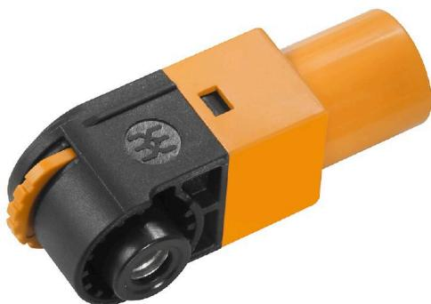
电池储能系统在可再生能源领域发挥着越来越重要的作用。它们通常由多个单独的电池组成，可以方便快捷地进行更换。魏德米勒电池连接器 (WBC) 可以将若干个单独的电池连接到储能系统中，只需要几个简单的步骤，而且在必要时也能迅速断开连接。为了提升安全性和操作的便利性，两极都设有明确标记：正极为橙色，负极为黑色。
