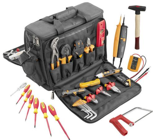
车间和工厂里，如果能够把各类工具有条理的管理起来，可以节省大量时间并提高工作效率。魏德米勒出于这一考虑，提供高质量、多功能的工具组套，组套包括用于切线和剥线的压接套件和压接管状端头。
