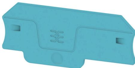
分隔板与端板是接线端子的必要附件。分隔板可实现不同电位和功能组的光学与电气隔离，提升安全性并确保控制柜内部结构清晰明了。端板用于封闭接线端子排的侧面，防止接触带电部件，同时确保整体结构整洁稳固。这两类组件均与魏德米勒相应的接线端子产品系列精确匹配，有助于实现安全、合规且专业的接线。
