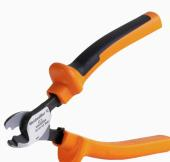
用于外径最大 8 mm、12 mm、14 mm 和 22 mm 的导线的切割工具。特殊的刀片几何形状允许以最小体力对铜和铝导线进行无挤压切割。根据 EN/IEC 60900 标准, 切割工具 (KT 8 至 KT 22) 还配备通过 VDE 和 GS 测试的保护绝缘层, 电压最高可达 1,000 V。
