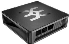
U-Maker 接线盒为您使用树莓派 (Raspberry Pi) 计算机实现您自己的应用程序提供了理想的基础。模块化的可扩展外壳具有众多功能，令人印象深刻。内部附件支持安装电子组件、第三方电路板和其他组件。外部支架兼容简单动作凸轮附件。这使 U-Maker 接线盒可以灵活地安装在许多位置或补充外部附件。
