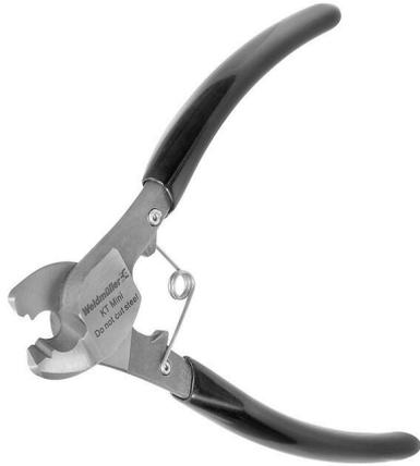
用于外径最大 8 mm、12 mm、14 mm 和 22 mm 的导线的切割工具。特殊的刀片几何形状允许以最小体力对铜和铝导线进行无挤压切割。根据 EN/IEC 60900 标准，切割工具（KT 8 至 KT 22）还配备通过 VDE 和 GS 测试的保护绝缘层，电压最高可达 1,000 V。
