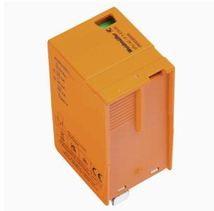
魏德米勒 VPU I (I级)、VPU II (II级)和VPU III (III级) 电涌保护器产品能够有效减少瞬时放电引起的干扰耦合, 使之大大低于 EN 60664-3 / DIN VDE 0110-3 标准的要求值。这也减少了装置的故障率。通过技术手段实现电涌保护器的协调作用。因此 I 级、II 级和 III 级装置之间无需断开。放电管符合 IEC 61643-11 / DIN EN 61643-11 产品标准, 且根据 IEC 61643-12 / VDE 0675-6-12 标准和 IEC 62305-4 / VDE 0185-4 标准可以用于系统内。本避雷/电涌保护装置适用于电源系统。魏德米勒将根据具体供电网络的类型和电压水平提供不同的产品。VPU AC I F 系列的特点是在避雷器中集成了保险丝。这些避雷器不需要保险丝。
