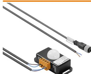
用于 WIL-LED 照明灯的运动检测器，螺钉联接，3m 电源电缆和 M12 电缆用于连接至 WIL 灯。切换时间可调节。
