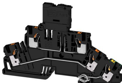
保险接线端子与组件接线端子可将保护元件和功能元件直接集成到端子条中。保险接线端子内置保险丝座，能可靠保护电路免受过载损害，是控制与配电系统的理想选择。组件接线端子可将二极管、电阻器或 LED 等电子元件直接集成到接线中。这有助于以节省空间且布局清晰的方式实现开关功能和信号隔离。两类接线端子共同确保了更高的安全性、便于维护，并实现紧凑型功能导向的安装。
