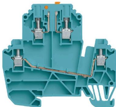
在某些应用中，我们会需要出于测试和安全目的向直通型接线端子添加一个测试点或开关元件。使用开关型端子，您可在无电压的情况下对电路进行测量。由于开关点的电气间隙和爬电距离无法评估尺寸，我们必须对指定的额定脉冲电压强度进行论证。
