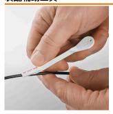
SlimFix 是带有节约空间的思想设计出来的导线和电缆标记 号。可以在导线安装完成后再安装标记号。标记号由无卤素的材料制成,并且满足阻燃等级 VO/V2 的要求。SlimFix 在交通轨道行业中得到广泛认可和应用。SF 工具可以使非 常小的导线也很容易安装。
