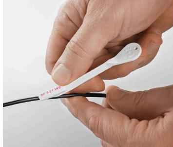
SlimFix 是带有节约空间的思想设计出来的导线和电缆标记号。可以在导线安装完成后再安装标记号。标记号由无卤素的材料制成，并且满足阻燃等级 VO/V2 的要求。SlimFix 在交通轨道行业中得到广泛认可和应用。SF 工具可以使非常小的导线也很容易安装。
