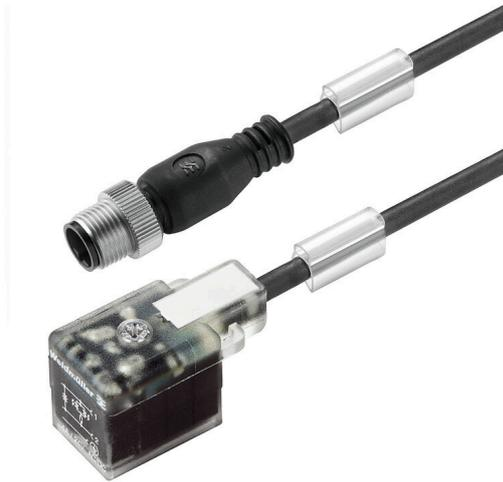
魏德米勒可以提供阀塞作为连接线，其中带有 M8/M12 插头，且单侧开放。阀塞的状态用一个 LED 显示。每个阀塞都有一个保护电路。魏德米勒系列包括符合 DIN 和工业标准的 A、B 和 C 型阀塞。阀塞拧紧后可达到 IP 67 防护等级。出口方向也是一个决定性因素，因此魏德米勒提供不同出口方向的版本。
