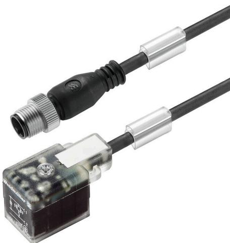
魏德米勒可以提供阀塞作为连接线，其中带有 M8/M12 插头，且单侧开放。阀塞的状态用一个 LED 显示。每个阀塞都有一个保护电路。魏德米勒系列包括符合 DIN 和工业标准的 A、B 和 C 型阀塞。阀塞拧紧后可达到 IP 67 防护等级。出口方向也是一个决定性因素，因此魏德米勒提供不同出口方向的版本。
