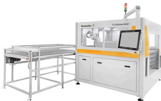
Klippon® Automated RailAssembler 可实现接线端子条的全自动组装。与魏德米勒产品配置器 (WMC) 相结合, 使用该自动化系统就不需要在生产过程中挑选、分配和定位每个接线端子。通过这种方式, 在常规装配过程中可以节省高达 60% 的时间。在无人操作的情况下, 其价值将更加显著。
