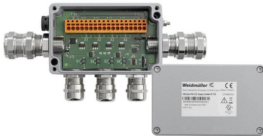
对于标准工业应用（非危险区域）， PROFIBUS PA 接线箱和限制器可提供1向、2向、4向、8向分线盒系列产品。FBCon 限制器的设计是为了保护连接的现场设备免受过电压和短路的影响。作为电压限制保护元件，使用抑制二极管。由于集成电流限制，该段还可防止支线上的短路。EMC 电缆接头，IP66 防护等级和广泛的工作温度范围可在恶劣环境中安全保护您的联接。
