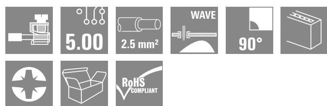
采用片簧联接的印刷线路板接线端子，间距为 5.00 和 5.08 mm。导线出线方向 90°。适用于最大 2.5 mm<sup>2</sup> 的导线截面积。
