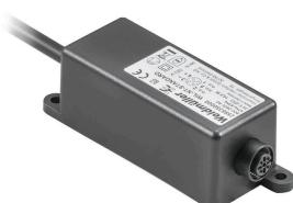
防护等级 IP65 的电源，用于 WIL 标准系列，85V-264V 交流输入。24V 直流输出 400mA
