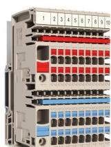
独特的模块化概念可根据各种类型的机器进行定制。电位分配接线端子 AAP 的成功之处在于其使用两种构造——交替或成组的统一设计方式。在控制电压分配的交替设计下，两种电位都只位于一个接线端子上。
