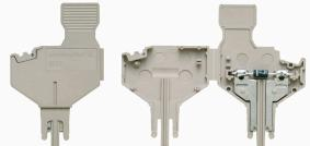
插头组件用于将电气组件安装在可拆式接线端子。电子组件完成焊接之后, 可以将插头安装到可拆式接线端子的断开区域, 从而将可拆式接线端子变成配有内置电子组件的模块化接线端子。
