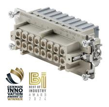
利用 SNAP IN 连接时,导体连接层已打开,可轻松插入已 剥线的联接器。在终点位置,具有专利的夹紧机构将自动 关闭。所以实际使用过程不需要维护,并且构建了安全、 永久且防震动的连接。因此,Weidmüller 成为了首家也是 唯一一家提供这种创新连接系统的制造商。极数: 6-24
