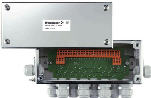
对于标准工业应用（非危险区域），PROFIBUS PA 接线箱和限制器可提供 1 向、2 向、4 向、8 向分线盒系列产品。FBCon 限制器的设计是为了保护连接的现场设备免受过电压和短路的影响。作为电压限制保护元件，使用抑制二极管。由于集成电流限制，该段还可防止支线上的短路。EMC 电缆接头，IP66 防护等级和广泛的工作温度范围可在恶劣环境中安全保护您的联接。
