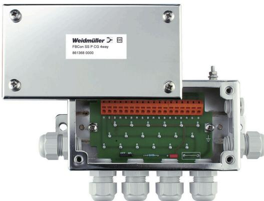
对于标准工业应用（非危险区域），PROFIBUS PA 接线箱和限制器可提供 1 向、2 向、4 向、8 向分线盒系列产品。FBCon 限制器的设计是为了保护连接的现场设备免受过电压和短路的影响。作为电压限制保护元件，使用抑制二极管。由于集成电流限制，该段还可防止支线上的短路。EMC 电缆接头，IP66 防护等级和广泛的工作温度范围可在恶劣环境中安全保护您的联接。
