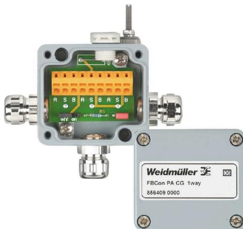
对于标准工业应用（非危险区域），PROFIBUS PA 接线箱和限制器可提供 1 向、2 向、4 向、8 向分线盒系列产品。FBCon 限制器的设计是为了保护连接的现场设备免受过电压和短路的影响。作为电压限制保护元件，使用抑制二极管。由于集成电流限制，该段还可防止支线上的短路。EMC 电缆接头，IP66 防护等级和广泛的工作温度范围可在恶劣环境中安全保护您的联接。
