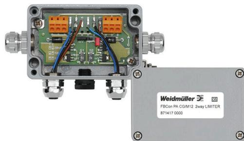
对于标准工业应用（非危险区域），PROFIBUS PA 接线箱和限制器可提供1向、2向、4向、8向分线盒系列产品。FBCon 限制器的设计是为了保护连接的现场设备免受过电压和短路的影响。作为电压限制保护元件，使用抑制二极管。由于集成电流限制，该段还可防止支线上的短路。EMC 电缆接头，IP66 防护等级和广泛的工作温度范围可在恶劣环境中安全保护您的联接。
