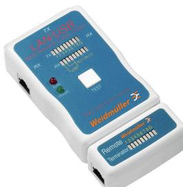
导通电阻测试仪完全绝缘的塑料外壳抗拉、防裂，因此也特别适用于在恶劣条件下的日常使用。内置的手电筒有助于快速、安全地找出有缺陷的导线。导通电阻测试不仅可以采用视觉显示，也可以采用声音显示。
