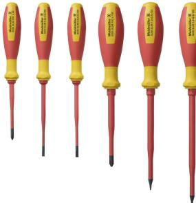
VDE 绝缘螺丝刀, 用于最高处于交流 1000 V 和直流 1500 V 电压下的部件, DIN EN 60900, IEC 900。已通过 "GS" 安全测试, 组件已通过测试. Klinge aus hochlegiertem Chrom-Vanadium-Molybdän-Stahl, 槽刀由高品质 铬-钒-钼-钢 合金制成, 持续硬化处理, 发蓝处理
