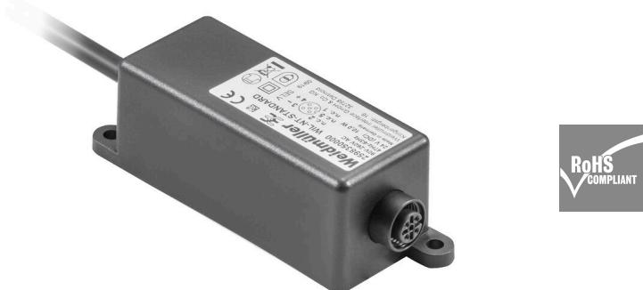
防护等级 IP65 的电源，用于 WIL 标准系列，85V-264V 交流输入。24V 直流输出 400mA
