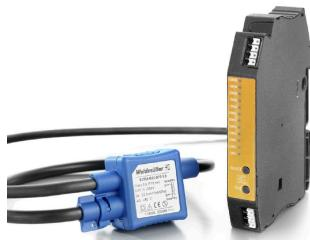
罗氏线圈罗氏线圈是一种闭合的空气线圈，没有铁磁芯用于交流和脉冲电流的浮动电位测量。使用罗氏线圈的测量广泛应用于技术领域，因为它可以追加集成到系统中，无需在现有系统中分离初级电路。由于该方法不会产生饱和效应，因此即使是最小的电流和高频谐波也能在不损失精度的情况下进行测量。
