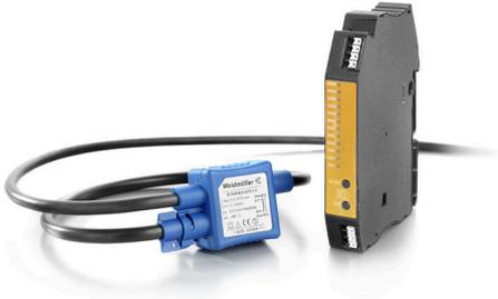
罗氏线圈是一种闭合的空气线圈，没有铁磁芯用于交流和脉冲电流的浮动电位测量。使用罗氏线圈的测量广泛应用于技术领域，因为它可以追加集成到系统中，无需在现有系统中分离初级电路。由于该方法不会产生饱和效应，因此即使是最小的电流和高频谐波也能在不损失精度的情况下进行测量。
