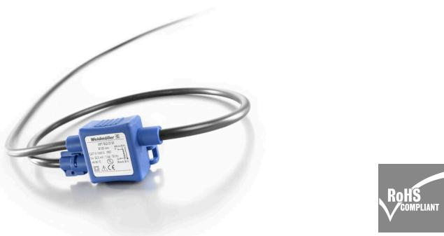
罗氏线圈罗氏线圈是一种闭合的空气线圈，没有铁磁芯用于交流和脉冲电流的浮动电位测量。使用罗氏线圈的测量广泛应用于技术领域，因为它可以追加集成到系统中，无需在现有系统中分离初级电路。由于该方法不会产生饱和效应，因此即使是最小的电流和高频谐波也能在不损失精度的情况下进行测量。
