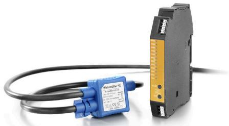
罗氏线圈罗氏线圈是一种闭合的空气线圈，没有铁磁芯用于交流和脉冲电流的浮动电位测量。使用罗氏线圈的测量广泛应用于技术领域，因为它可以追加集成到系统中，无需在现有系统中分离初级电路。由于该方法不会产生饱和效应，因此即使是最小的电流和高频谐波也能在不损失精度的情况下进行测量。
