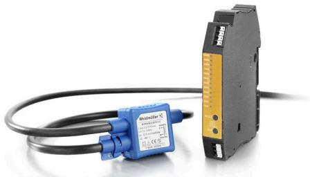
罗氏线圈罗氏线圈是一种闭合的空气线圈，没有铁磁芯用于交流和脉冲电流的浮动电位测量。使用罗氏线圈的测量广泛应用于技术领域，因为它可以追加集成到系统中，无需在现有系统中分离初级电路。由于该方法不会产生饱和效应，因此即使是最小的电流和高频谐波也能在不损失精度的情况下进行测量。
