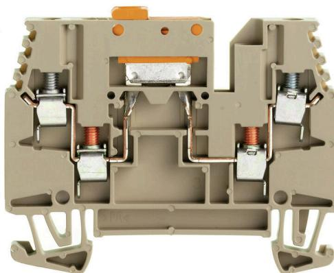
在某些应用中，我们会需要出于测试和安全目的向直通型接线端子添加一个测试点或开关元件。使用开关型端子，您可在无电压的情况下对电路进行测量。由于开关点的电气间隙和爬电距离无法评估尺寸，我们必须对指定的额定脉冲电压强度进行论证。
