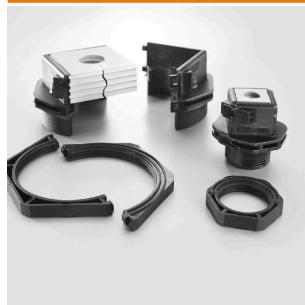
针对公制 M20 至 M63 的通孔，Cabtite 电缆进线系统提供可分离的电缆接头用于带插头和不带插头的电缆。在系统中进行维护或改动时，直径为 2 至 35 mm 的预组装电缆可以快速安全地插入到机柜或接线盒中。可靠的密封满足 DIN EN 60529 的 IP66 防护等级要求，绝对可靠的配件（基于 DIN EN 62444 的减张力备件）确保在插入电缆接头的一半或两半之前已有波形相交的槽型密封件环绕电缆周围放置。可分离的系统确保简单快速的安装。插入密封件后，电缆接头的两半简单地扣合在一起。一个同样也可分离的防松螺母位于机柜内侧，确保安全可靠的夹持。
