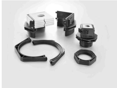
针对公制 M20 至 M63 的通孔, Cabtite 电缆进线系统提供可分离的电缆接头用于带插头和不带插头的电缆。在系统中进行维护或改动时, 直径为 2 至 35 mm 的预组装电缆可以快速安全地插入到机柜或接线盒中。可靠的密封满足 DIN EN 60529 的 IP66 防护等级要求, 绝对可靠的配件 (基于 DIN EN 62444 的减张力备件) 确保在插入电缆接头的一半或两半之前已有波形相交的槽型密封件环绕电缆周围放置。可分离的系统确保简单快速的安装。插入密封件后, 电缆接头的两半简单地扣合在一起。一个同样也可分离的防松螺母位于机柜内侧, 确保安全可靠的夹持。
