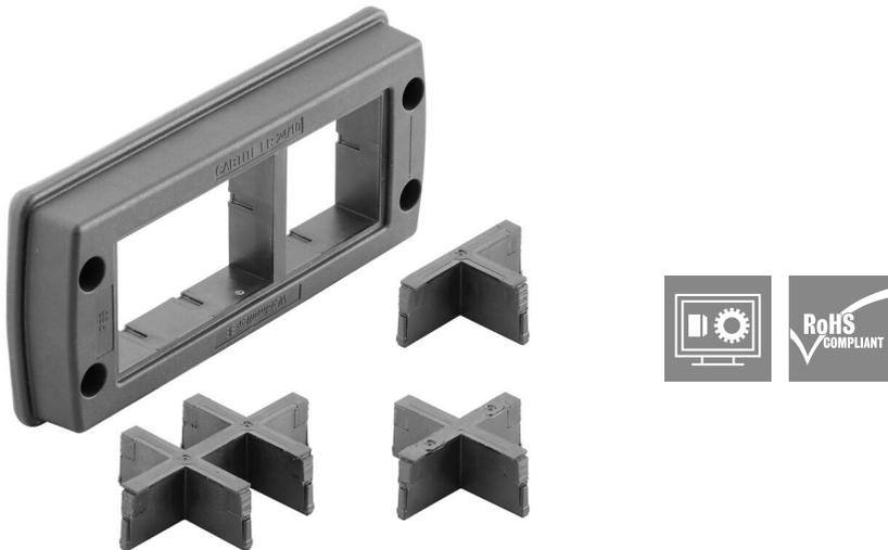
框架由单体构成，安装快速简单，材料为形状稳定的玻璃纤维增强型塑料。紧箍泡沫密封件确保有效的 IP66 密封符合 DIN EN 60529 标准，即使在涂层和粗糙表面上。
