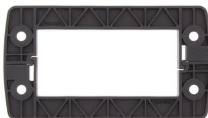
框架由单体构成，安装快速简单，材料为形状稳定的玻璃纤维增强型塑料。紧箍泡沫密封件确保有效的 IP66 密封符合 DIN EN 60529 标准，即使在涂层和粗糙表面上。
