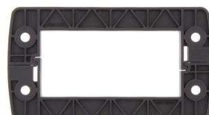
框架由单体构成, 安装快速简单, 材料为形状稳定的玻璃纤维增强型塑料。紧箍泡沫密封件确保有效的 IP66 密封符合 DIN EN 60529 标准, 即使在涂层和粗糙表面上。
