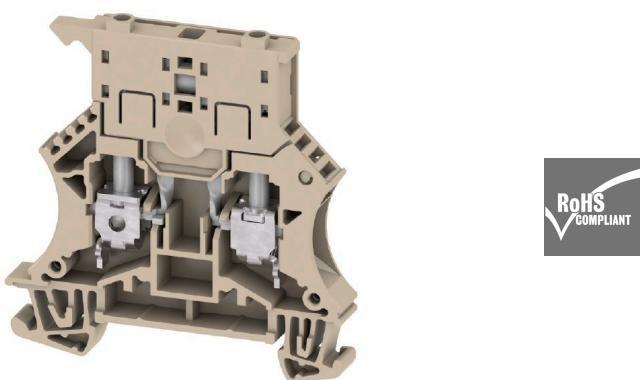
保险接线端子与组件接线端子可将保护元件和功能元件直接集成到端子条中。保险接线端子内置保险丝座，能可靠保护电路免受过载损害，是控制与配电系统的理想选择。组件接线端子可将二极管、电阻器或 LED 等电子元件直接集成到接线中。这有助于以节省空间且布局清晰的方式实现开关功能和信号隔离。两类接线端子共同确保了更高的安全性、便于维护，并实现紧凑型功能导向的安装。
