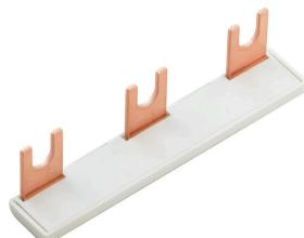
附近接线端子通过横联件实现电位分配或倍增。可轻松避免额外的接线工作。即使电极破损，仍能保证接线端子的接触可靠性。魏德米勒产品组合中有适合模块化接线端子的可插拔、可拧紧横联系统。
