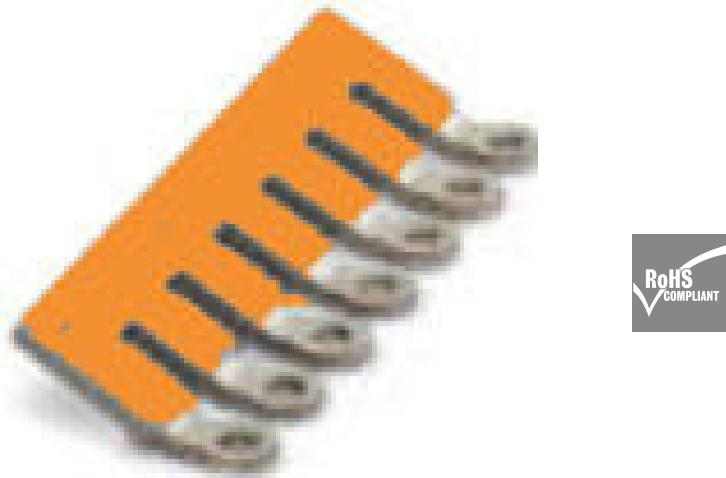
附近接线端子通过横联件实现电位分配或倍增。可轻松避免额外的接线工作。即使电极破损，仍能保证接线端子的接触可靠性。魏德米勒产品组合中有适合模块化接线端子的可插拔、可拧紧横联系统。
