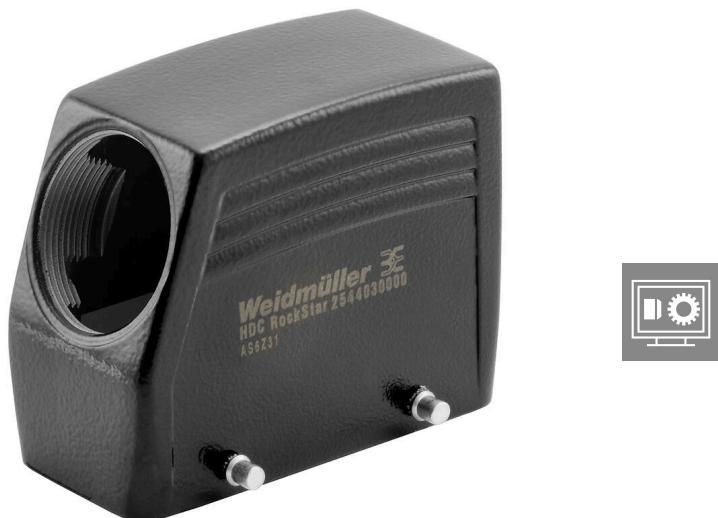
新型的魏德米勒 RockStar® IP65 EMC 接线盒是在最严苛环境条件中使用时的理想之选，提供能够抵御电磁影响的保护功能。重载接插件包含插芯和保护外壳。新型的塑料带易于锁定，可以随时更换。所有的魏德米勒 RockStar® 接线盒由高品质压铸铝制成。令产品抗冲击、耐腐蚀，同时结构紧凑，重量轻。
