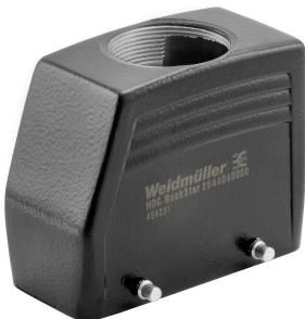
新型的魏德米勒 RockStar® IP65 EMC 接线盒是在最严苛环境条件中使用时的理想之选，提供能够抵御电磁影响的保护功能。重载接插件包含插芯和保护外壳。新型的塑料带易于锁定，可以随时更换。所有的魏德米勒 RockStar® 接线盒由高品质压铸铝制成。令产品抗冲击、耐腐蚀，同时结构紧凑，重量轻。
