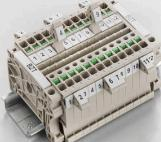
标识牌支架允许以 5 或 5.1 mm 的节距额外安装标准标识牌。倾斜支架可以选择性地卡扣在一起，并可以安装在 Klippon® Connect 模块化端子排的所有标准标记通道中。匹配的标识牌类型可以在指派标记支架的相应附件下方找到。
