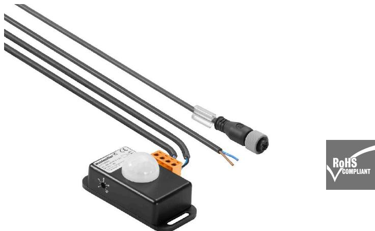
用于 WIL-LED 照明灯的运动检测器，螺钉联接，3m 电源电缆和 M12 电缆用于连接至 WIL 灯。切换时间可调节。
