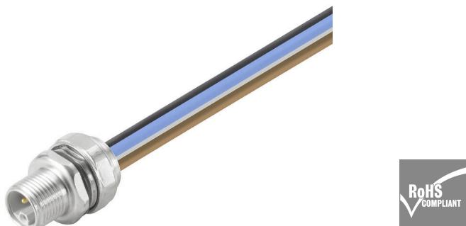
您的外围设备应配备更大的电源。借助我们新的 M12 接插件，超过 250 V 和 2 A 的电压不会出现任何问题。紧凑型 A-、K-、L-、S- 和 T-编码 M12 接插件用于传输最高 630 V 交流电或 60 V 直流电的电压以及 12 A 的电流。
