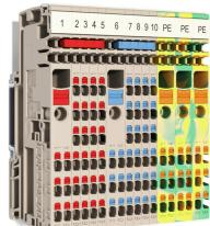
独特的模块化概念可根据各种类型的机器进行定制。电位分配接线端子 AAP 的成功之处在于其使用两种构造——交替或成组的统一设计方式。在控制电压分配的分组结构中，电位位于不同的接线端子上，从而形成了整体的电位端子。
